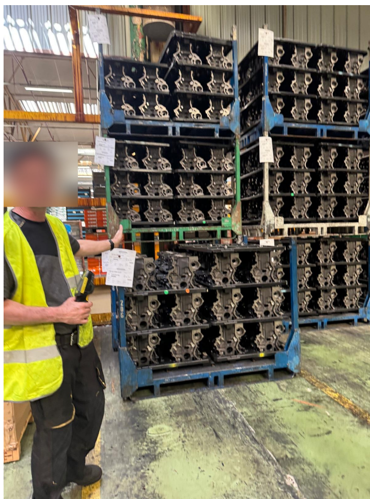
IMAGE 10. Un « TM » : palette à séparations plastiques regroupant un lot de carters contrôlés, utilisée pour leur stockage et leur transport dans l'atelier.
