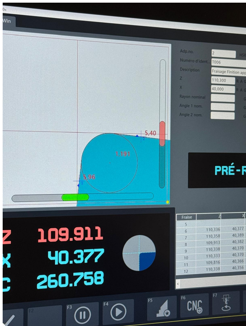
IMAGE 28. Écran du banc de préréglage d'outils (Zoller, logiciel pilot 4.0) : mesure du diamètre et de la position d'une fraise de finition avant remontage.
