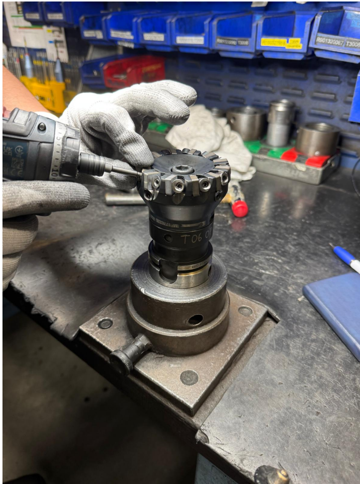
IMAGE 3. Changement d'une plaquette carbure sur une fraise de finition (cône HSK), à l'aide d'une visseuse dynamométrique.
