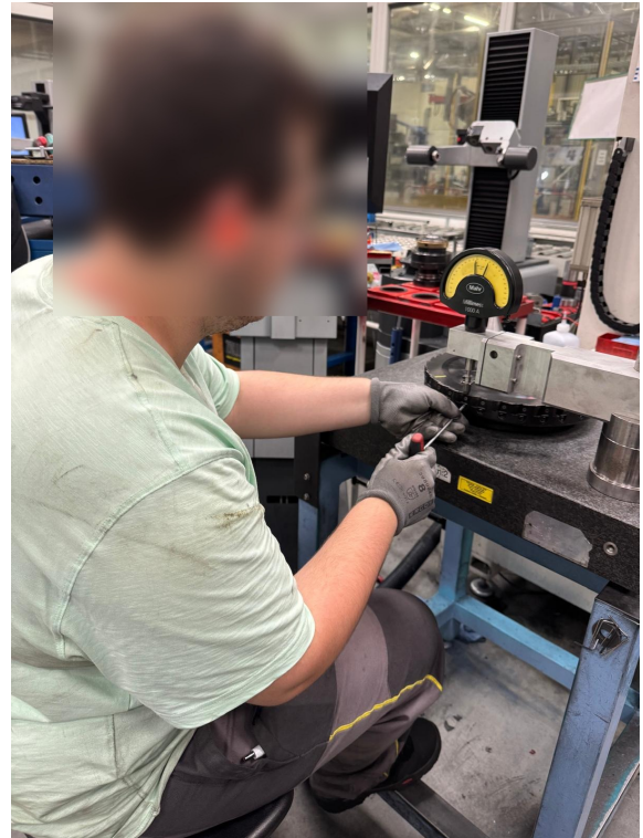
IMAGE 5. Réglage d'une fraise sur le marbre de métrologie, à l'aide d'un comparateur Mahr Millmess.
