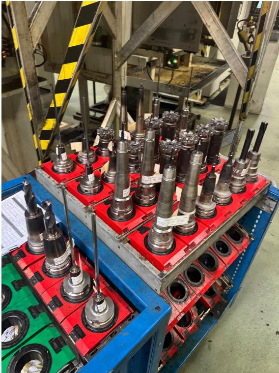
IMAGE 4. Chariot chargé de fraises et forets réglés, prêts à être remontés sur les postes de l'atelier.
