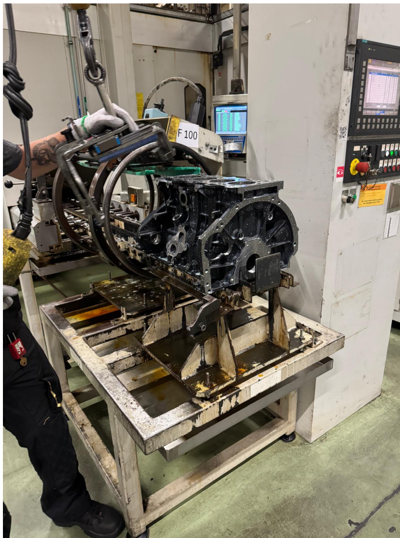
IMAGE 18. Manutention d'un carter-cylindres à l'aide d'un palonnier; l'étiquette « F100 » repère la face 100 du carter, utilisée pour le positionner correctement avant de le renvoyer sur le tapis qui le réintègre dans le cycle de la machine.
