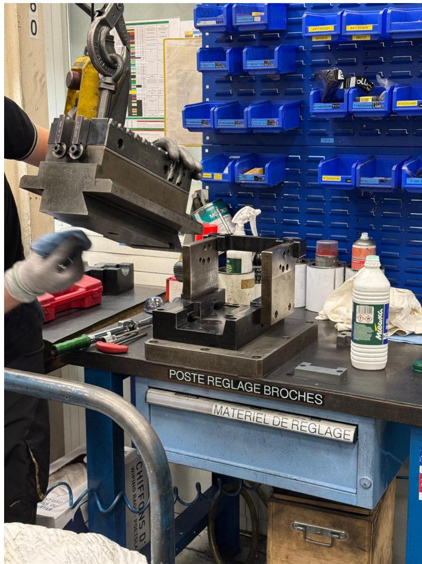
IMAGE 11. Poste de réglage des broches de l'atelier : réglage d'un outillage de précision suspendu au palan, sur son montage de référence.
