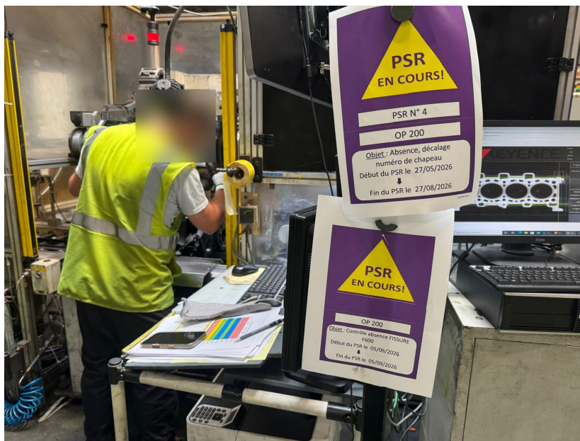
IMAGE 27. Poste de contrôle sous scanner laser, avec deux fiches de Plan de Surveillance Renforcé (PSR) affichées. La première porte sur l'« absence, décalage numéro de chapeau » : les cinq chapeaux de paliers d'un carter sont numérotés de 1 à 5 et doivent être montés dans cet ordre, mais il arrive que l'ordre soit inversé sur certains carters, voire que le numéro ne soit pas visible ; sans conséquence sur le fonctionnement du moteur, cet écart doit néanmoins être signalé à Nissan, qui l'exige contractuellement. Ce défaut fait écho au réglage des chapeaux de paliers décrit en section 3.5.
