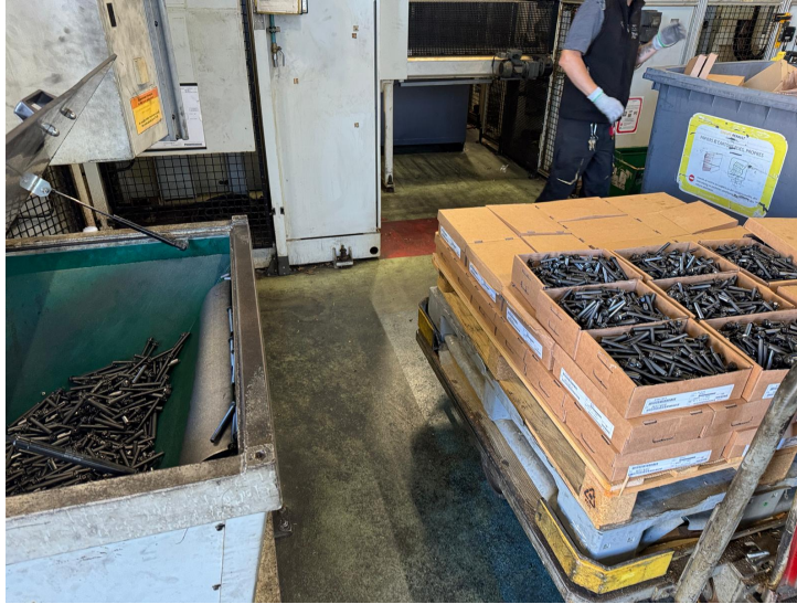
IMAGE 20. Bac de tri sélectif du groupe Renault (papiers et cartons pliés, propres), installé à proximité du poste où les vis sont transvasées depuis leur carton vers le réservoir de la machine qui visse les chapeaux de paliers sur le carter, un emplacement qui facilite directement le tri des cartons vidés.
