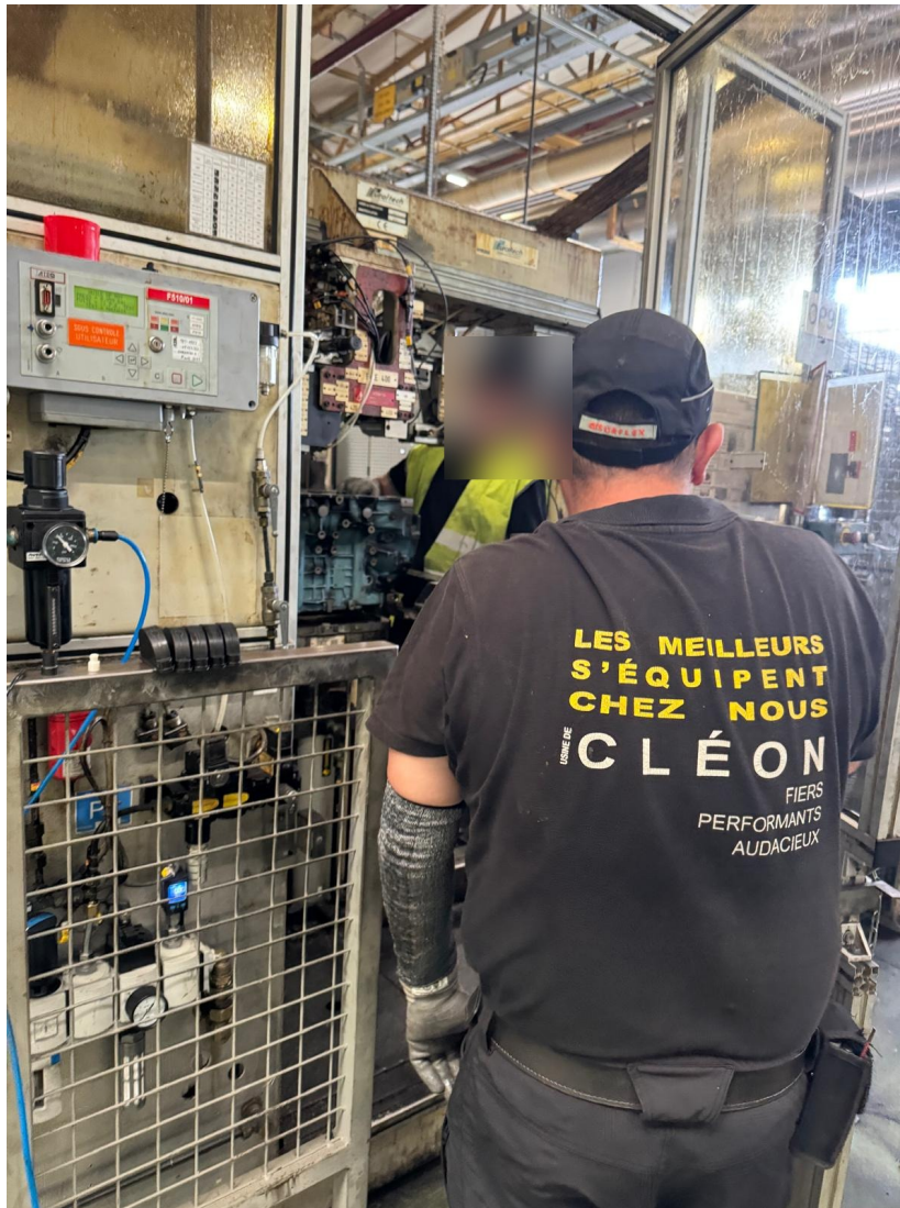
IMAGE 8. Le banc de contrôle d'étanchéité (boîtier ATEQ F510/01, à gauche) au moment de l'incident.
