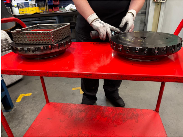
IMAGE 33. Fraises circulaires à plaquettes de la ligne d'usinage, posées sur un chariot d'atelier avant contrôle et remontage.
