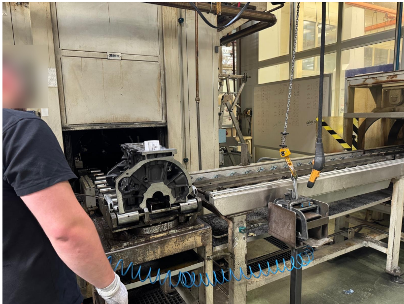
IMAGE 35. Carter-cylindres en sortie de machine à laver : le fil du pistolet à air comprimé (au premier plan) sert à souffler l'eau avant de faire glisser la pièce sur le tapis menant directement à la salle de contrôle 3D.
