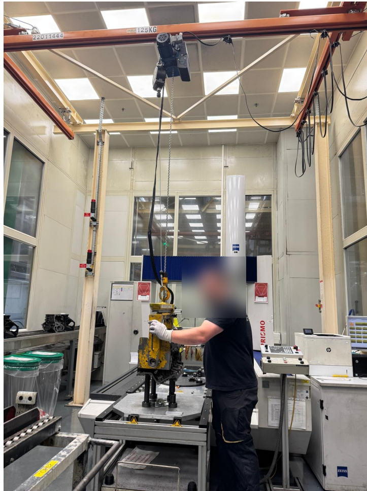
IMAGE 2. Positionnement d'un carter-cylindres sur le montage de la machine de métrologie tridimensionnelle Zeiss Prismo, à l'aide d'un palan à chaîne (capacité 125 kg).
