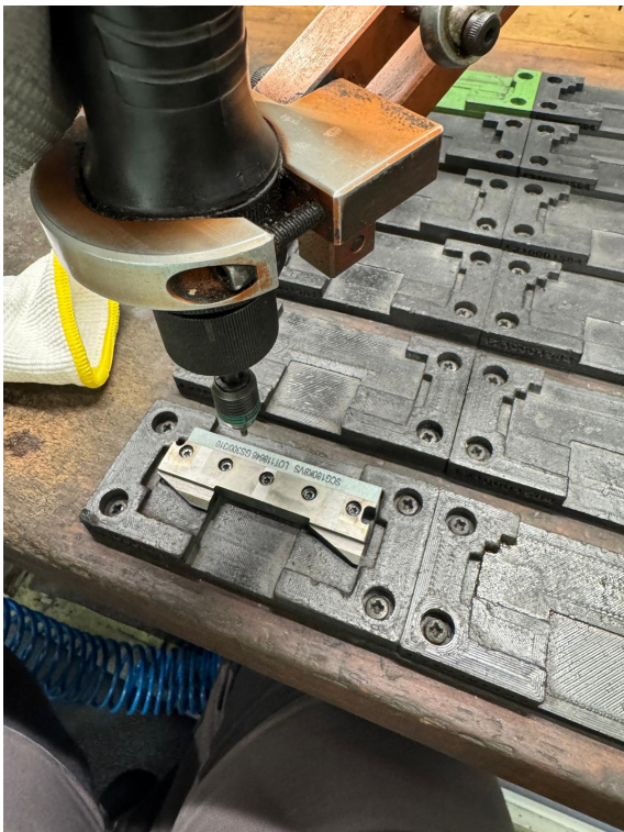
IMAGE 6. Changement d'une pierre de rôdage, montée dans son support.
