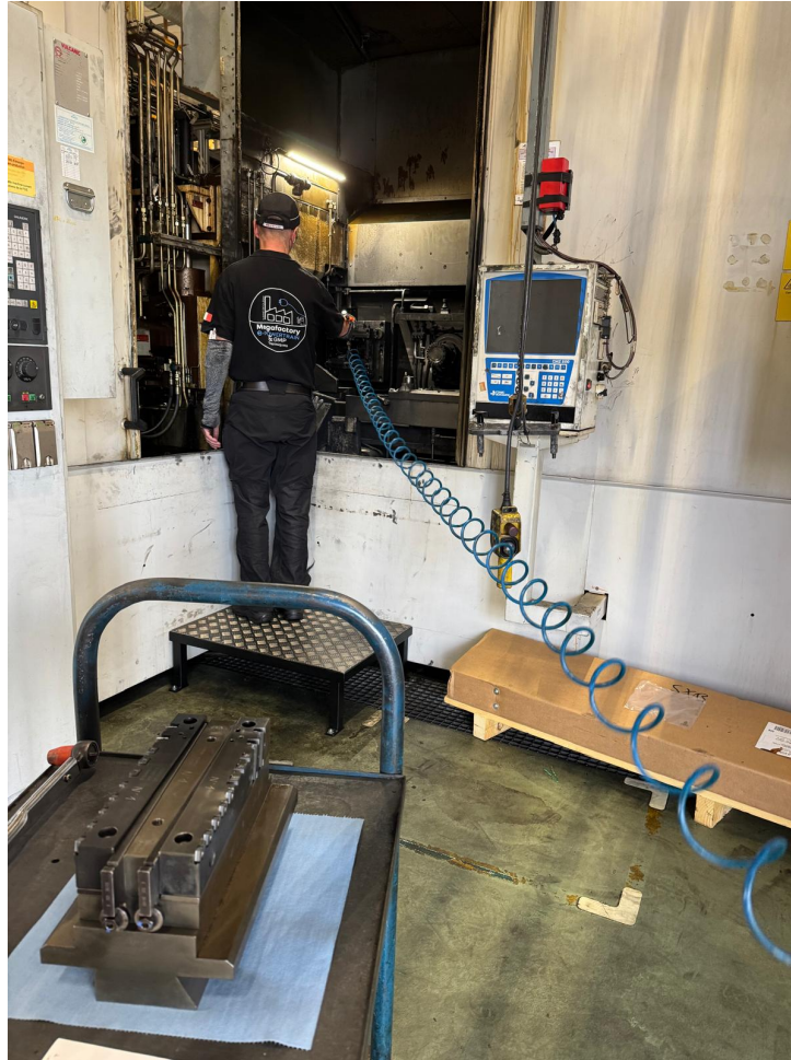
IMAGE 12. [REDACTED], chef d'équipe, réglant une broche à l'aide d'un souffleur à air haute pression pour en retirer les copeaux métalliques et le liquide de refroidissement.
